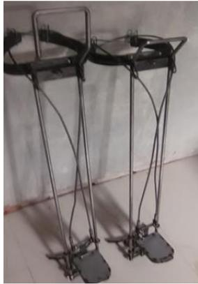
**Gambar 6. Alat Pemanjat Pohon Kelapa belum Dicat (80%)**
